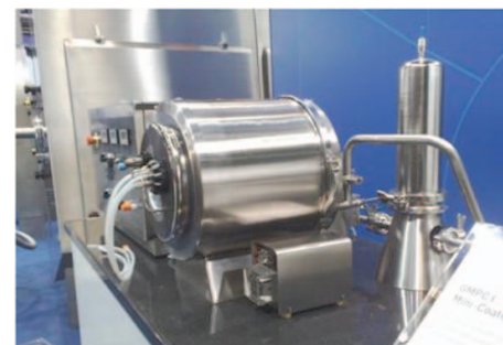
Фото 2. Машина для нанесения покрытия на таблетки «GMPC1», пр-ва фирмы «Glatt»
