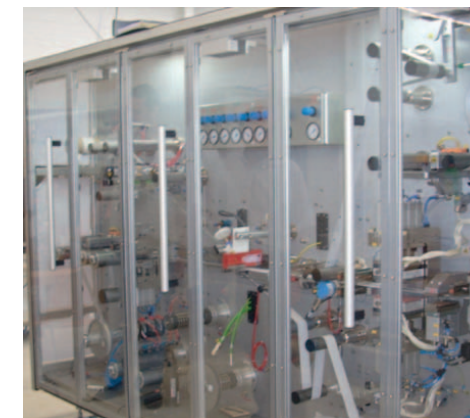
Фото 4. Лабораторная машина для получения трансдермальных пластырей и трансбуккальных пленок «PML-100», пр-ва фирмы «Harro Höfliger»
