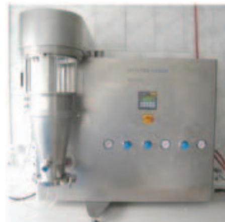
Фото 3. Установка для грануляции «Mucrolab», пр-ва фирмы Oyster Hüttline (технология «кипящего слоя»)
