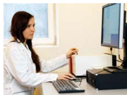
Рис. 1. Лаборатория аналитической микроскопии. Анализатор размеров частиц и стабильности образцов «NANOPHOX» фирмы SYMPATEC GmbH
