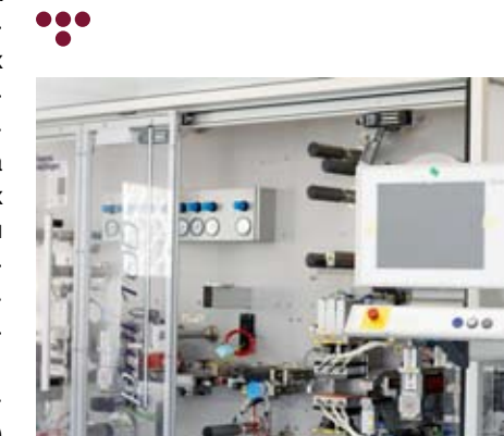
Рис. 4. Лаборатория промышленной фармацевтической технологии. Лабораторная машина упаковки трансдермальных пластырей и трансбуккальных пленок Harro Hoefliger «PML-100»
